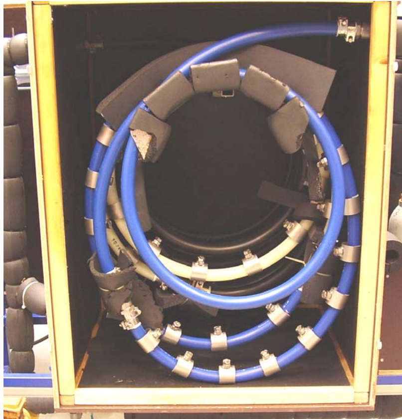
Bild 7: Umlaufapparatur zur Prüfung der Wärmealterung an punktbelasteten Rohren
